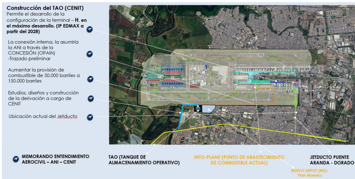
Gráfico 31. Esquema de operación red de combustible
